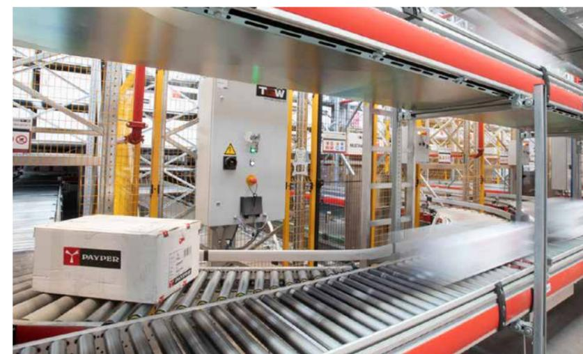
Unternehmensleistung durch die **technologische Entwicklung des Lagers** vorangetrieben. Das Unternehmen ging von einem System mit vollständig manueller Auftragsverwaltung zu einem integrierten System über, das den Auftrag vom Server empfängt, der wiederum Eingaben an das **automatische Lager** sendet, das den Prozess der Auftragszusammenstellung und des endgültigen Versands in Gang setzt.
